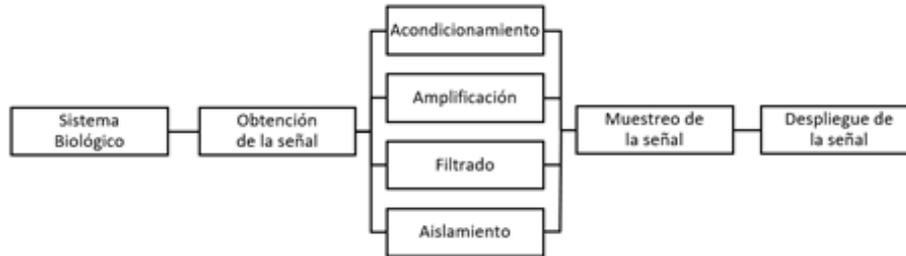
Fig.2. Diagrama de bloques del canal de instrumentación para la construcción del dispositivo.
