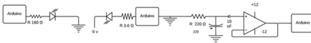
Fig.5. Diagrama electrónico completo del dispositivo.
