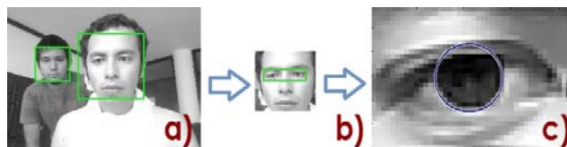
Fig. 2. Procesos de detección de rostro, par ocular y segmentación a un solo ojo.
