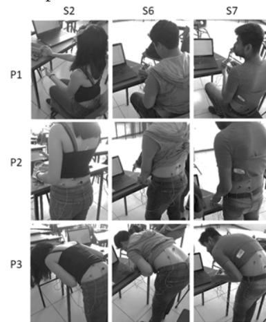
Fig. 6. Imágenes de las pruebas realizadas con el prototipo. En la figura se muestran 3 sujetos (S2, S6, S7) realizando 3 posiciones (P1, P2, P3) para registrar datos con los sensores.
