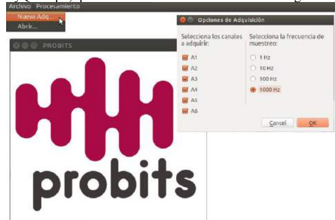
Fig. 2. Interfaz Probits, donde se selecciona 'Nueva Adquisición' en la barra de herramientas y se despliega una ventana que pide al usuario información sobre los canales y Fm deseados.
