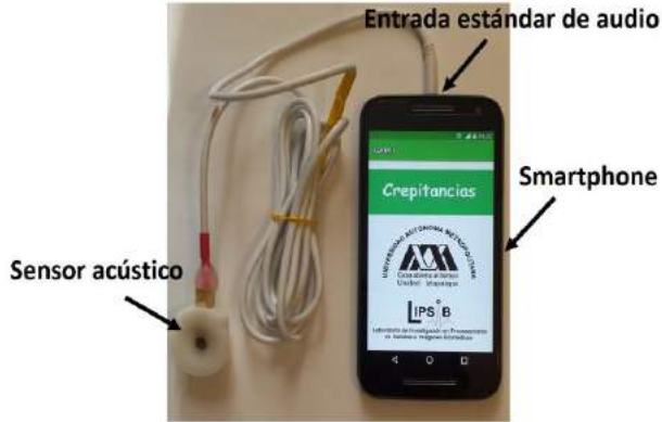
Fig. 1. Sistema móvil propuesto para la detección automática de estertores crepitantes.
