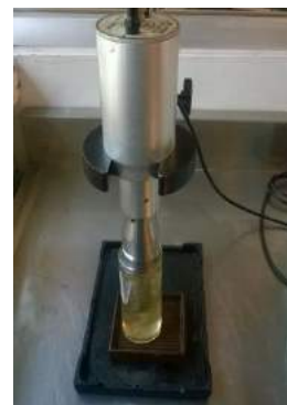
Fig. 2. Dispersión mecánica de HNTs en el hidrogel con uso de sonicador de punta.
