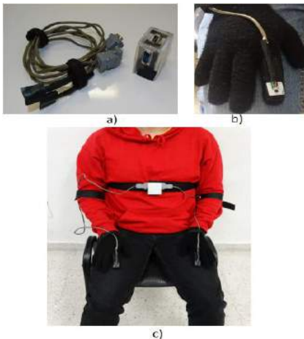
Fig. 1. a) Versión final del dispositivo, b) Colocación del ACC, c) Dispositivo final colocado en un sujeto de prueba.
