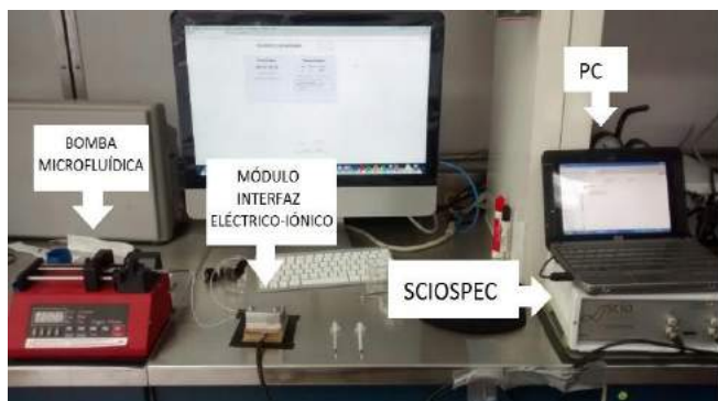
Fig. 2. Componentes del sistema biosensor de cADN.
