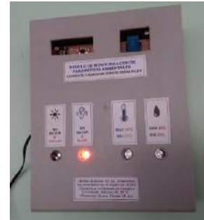
Fig. 3. Monitor de parámetros ambientales construido e instalado en una UCIN
