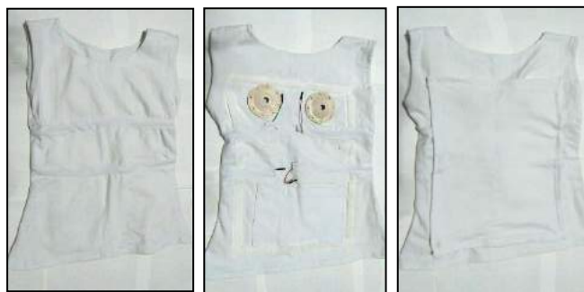
Fig. 3. La primera imagen pertenece a la parte frontal de la camisa en la cual se muestra los dos conductos. La segunda imagen es la parte posterior de la camisa, se puede observar las dos campanas de los micrófonos y las conexiones de los sensores de estiramiento. La tercera imagen corresponde igualmente a la parte posterior de la camisa pero con la capa adherible puesta.
