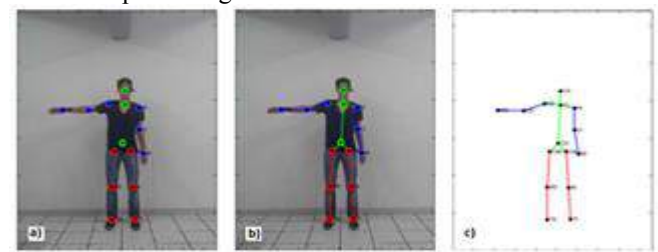
Fig. 3. Puntos articulares y visualización del esqueleto, a) Puntos sobre I. RGB; b) Esqueleto sobre I. RGB; c) Esqueleto sobre fondo blanco.
