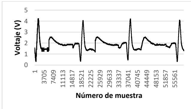
Fig. 7. Datos adquiridos por el Sistema propuesto, señal ECG sintética de 90 ppm, simulada con generador de funciones.
