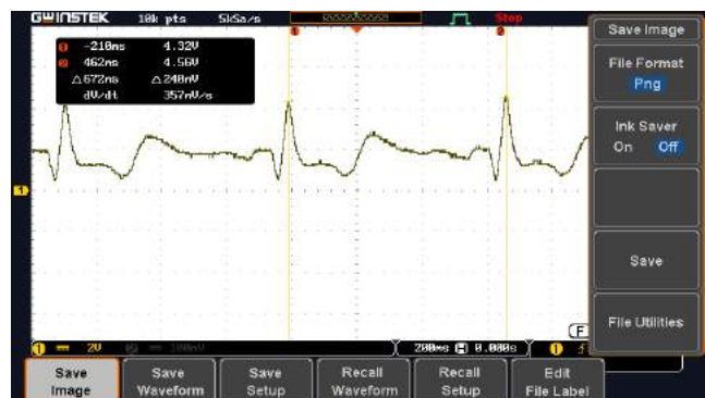
Fig. 6. Señal ECG sintética, simulada a 90 ppm con generador de funciones.
