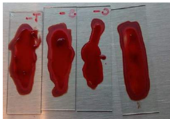
Fig. 4: (De izquierda a derecha) Muestra de señal triangular, senoidal, cuadrada y muestra de control en las pruebas de 9Hz, transcurridos 10 minutos desde que la sangre fue extraída.
