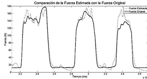
Fig. 5. Fuerza adquirida con electrodinámometro (continua) y la fuerza estimada con la función de transferencia (discontinua).
