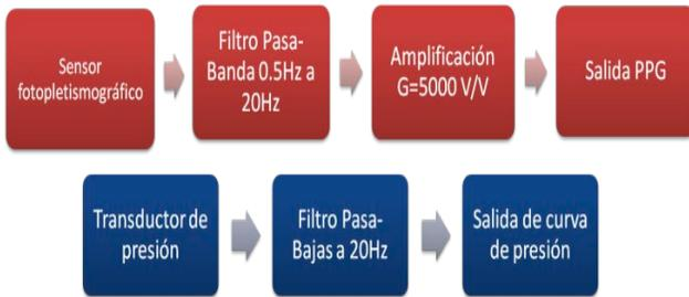
Fig. 1. Diagrama a bloques del dispositivo diseñado, en rojo el módulo de fotopletismografía y en azul el módulo de medición de la presión.
