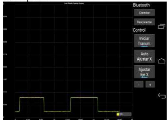
Fig. 7. Pantalla principal de la aplicación desplegando una señal periódica.
