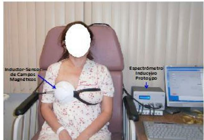
Fig. 2. Medición de EIM con sujetador ergonómico de sensores magnéticos coaxialmente centrado en glándula mamaria de una voluntaria. El sistema se encuentra conectado a Espectrómetro Inductivo Prototipo.
