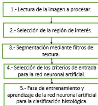
Figura 1: Diagrama de bloques del procesamiento de la imagen de ultrasonido intravascular.
