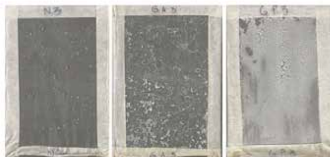
Fig. 4. Recubrimientos después de 480 horas en ambiente salino: a) Metal base, b) GPTMS en ácido acético, y c) GPTMS en PMAA
