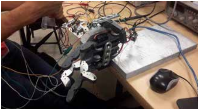
Figura 6. Modelo de prótesis mioeléctrica de mano utilizado para representar de manera visual la respuesta del sistema de control generado.
