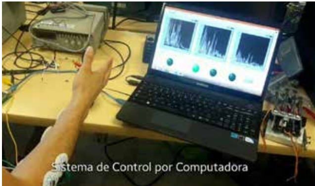
Figura 5. Sistema de control por computadora de un modelo de prótesis mioeléctrica de mano, interfaz generada en LabView.
