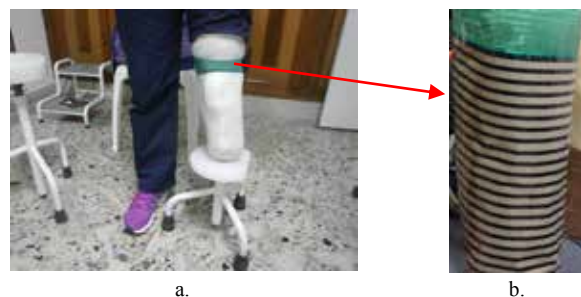
Fig. 4. a) Paciente usando el socket obtenido con impresión 3D y b) sensor de presión cubriendo muñón
