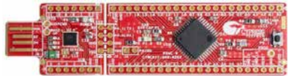
Fig. 6: PSoC CY8C425. Tarjeta de desarrollo con bootloader y puerto USB en la misma tabilla.
