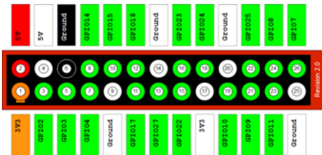
Fig. 4 Puerto de propósito general de la Raspberry [10].
