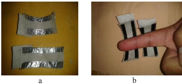
Fig. 6 Montaje de los electrodos de aluminio (a) y PPI (b)
