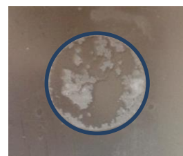
Fig. 7. Prueba potenciostato recubrimiento GPTMS en PMAA NaCl al 0.9%.
