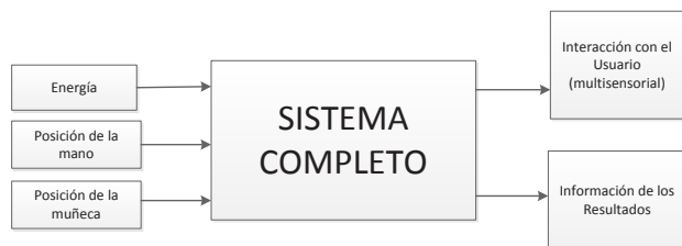
Fig. 1 Diagrama de caja negra del sistema
