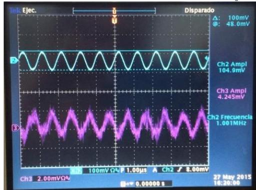
Figura 9.- Señal de entrada de 1MHz, amplitud 10 mVp-p (morado). Onda de salida señal amplitud 104.9 mV p-p (azul).
