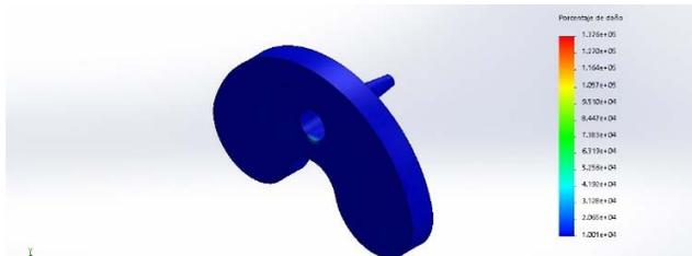
Figura 16. Porcentaje de daño en prótesis de patela (sin daño aparente).
