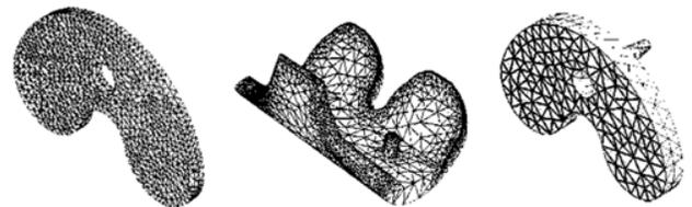
Figura 9. Aplicación de mallado basado en curvaturas.
