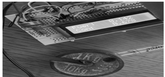
Fig. 4. Comportamiento del sensor respecto a la fuerza aplicada y la conductancia del sensor.
