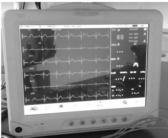
Fig. 6. Despliegue de la señal de ECG a 60 latidos por minuto en el monitor de signos vitales.
