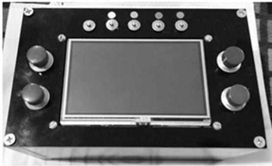
Fig. 5. Prototipo final obtenido en este trabajo. De izquierda a derecha, se conectan los electrodos de la siguiente manera: LA, RA, V1, LL, RL.
