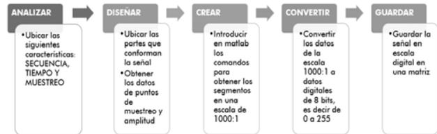
Fig.3. Esquema para el diseño de señales cardíacas en matlab
