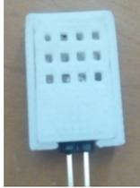
Fig. 6. Sensor de humedad
