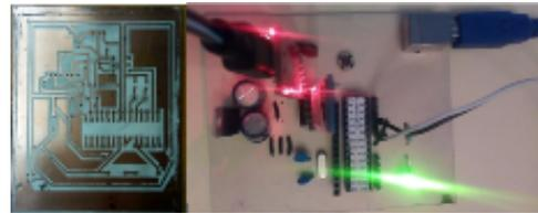
Fig. 10. Prototipo físico soldado por la parte inferior y mostrando en la parte superior los componentes implementados a la placa.
