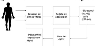
Fig. 2. Diagrama de bloques para la adquisición vía remota de signos vitales utilizando tecnologías del internet de las cosas IoT.
