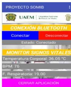
Fig. 12. Pantalla de la aplicación móvil para Android, utilizando la comunicación Bluetooth con el prototipo de signos vitales.
