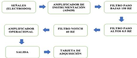
Fig. 6. Diagrama de bloques del diseño de Filtros ECG
