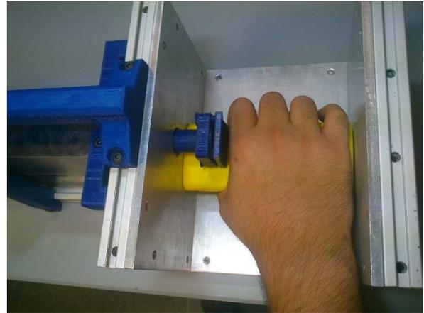
Fig. 5. Fotografía de vista superior del dispositivo compresor realizando una MCG automática.
