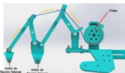
Fig. 5. Mecanismo de retroalimentación de fuerza.
