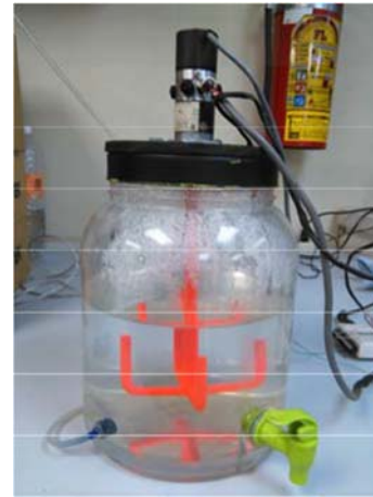
Fig. 3. Biorreactor construido para docencia en prácticas de laboratorio.
