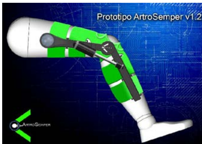
Fig. 2. Diseño conceptual de la nueva versión de ArthroSemper v1.2. El agente térmico está dado por los cojinetes verdes circulares que abarcan los ligamentos principales que rodean la rótula. El agente mecánico de tracción esta ejemplificado por el sistema de movimiento angular generado por los dos puntos de apoyo del servoactuador lineal. El agente electromagnético de corriente eléctrica está representado como equipo TENS guardado en el contenedor principal ubicado en la parte superior del soporte lateral de aluminio. La media esfera de leds es indicadora del proceso de rehabilitación que se está llevando a cabo.
