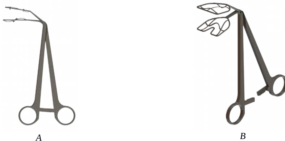
Figura 3: A) vista isométrica de la pinza para mostrar el detalle de las láminas de presión y la angulación del mango. B) Vista lateral del dispositivo.
