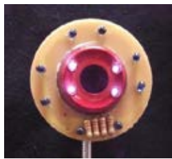
Fig. 3. Cámara con el sistema de iluminación acoplado.
