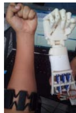
Fig. 5. El mecanismo imita el movimiento de cerrar el puño.
