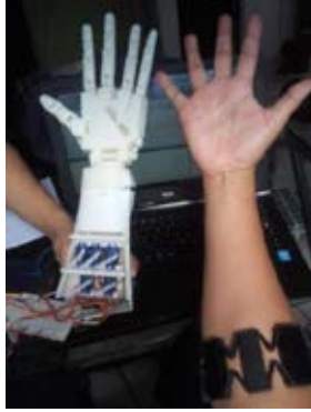
Fig. 6. El mecanismo imita la extensión de la mano.
