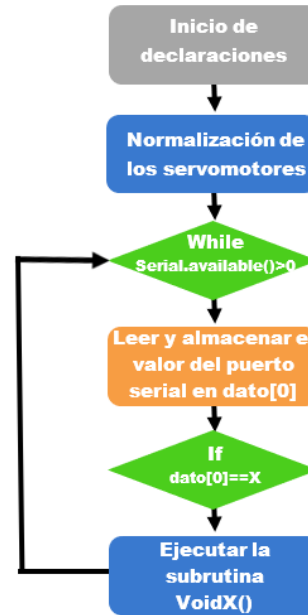
Fig. 4. Diagrama de bloques de la programación aplicada al dispositivo.
