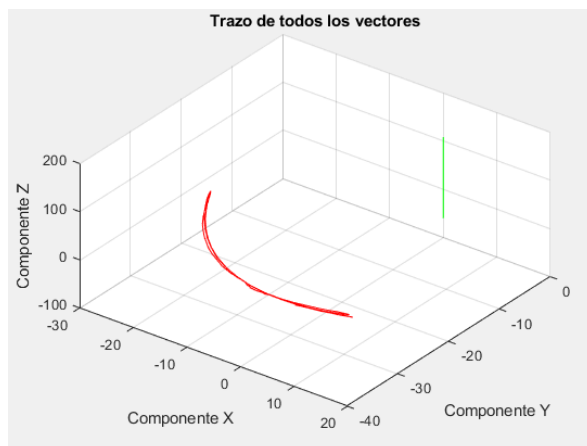
Fig. 7. Movimiento de rotación aproximado realizado dentro de las pruebas (línea roja) y vector “r” obtenido como referencia del eje de rotación (línea verde).
