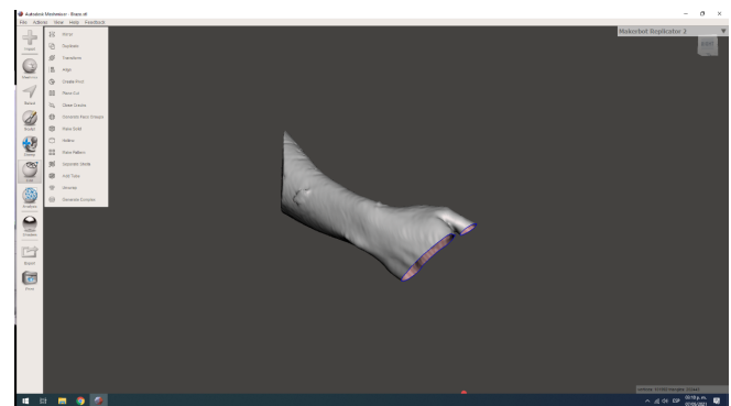
Fig. 3. Cortes transversales a través del brazo para reducir el tamaño de la férula lo más cerca posible a la muñeca.
