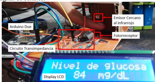
Fig. 2. Construcción y operación del dispositivo.
