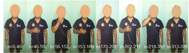
Figura 2. Posiciones del sensor MPU-6050 en la muñeca derecha para detectar estado en reposo y acercamiento a la cara.
