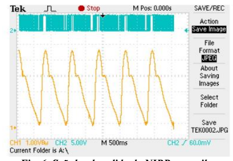
Fig. 6. Señales de salida de NIBP en osciloscopio
